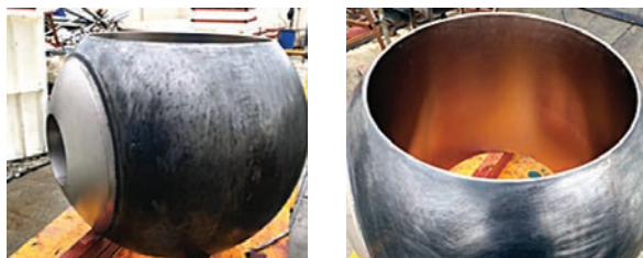
شکل ۲- نمایشی از سطوح پوشش داده شده توسط فرایند الکترولس (Ni-P، الف) سطح داخلی و (ب) قسمت هایی از سطح خارجی
