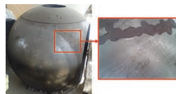
شکل ۱- نمایشی از تخریب پوشش کاربید تنگستن- کبالت- کروم بال ۳۲ اینچ
