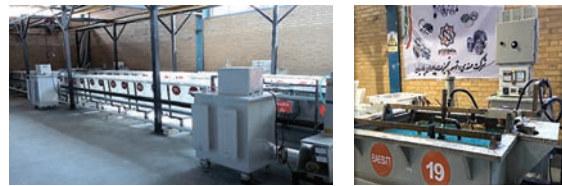
شکل ۳. نمایی از خط راه اندازی شده که در آن آبکاری نیکل، بابت و قلع به صورت Continuous (پشت سر هم) انجام می شود
