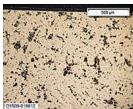
شکل ۲. رفتار پوشش بر روی سطح دارای عیوب ریخته گری
