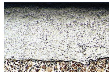
شکل ۷- تصویر گرفته شده توسط میکروسکوپ نوری از سطح مقطع پوشش کاربرد تنگستن- کبالت- کروم
