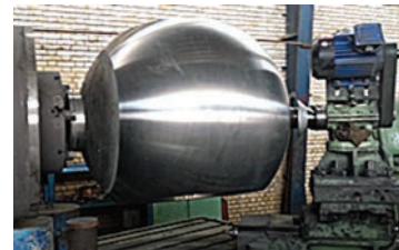
شکل ۶- نمایی از الف) پوشش دهی سطح خارجی و ب) سنگ زنی بال ۳۲ اینچ
