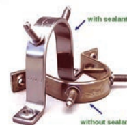
شکل ۱۲. سطح براق قطعه ی پوشش داده شده توسط آلیاژ روی-نیکل با پسیواسیون در مقایسه با قطعه ی بدون پسیواسیون
