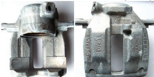
شکل ۹. دو قطعه‌ی چدنی پس از ۱۰۰۰ ساعت تست پاشش نمک
