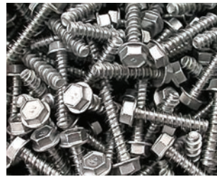
شکل ۳. نمونه‌ای از قطعات پوشش داده شده توسط آلیاژ روی-نیکل طی فرآیند آبکاری بارل
