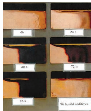
شکل (۱۱): نتایج حاصل از آزمایشات هال سل نمونه های محلول آبکاری
